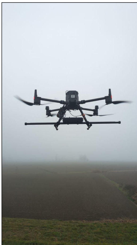
Immagine - Esecuzione del rilievo magnetometrico con MagDrone R3-Sensys.
