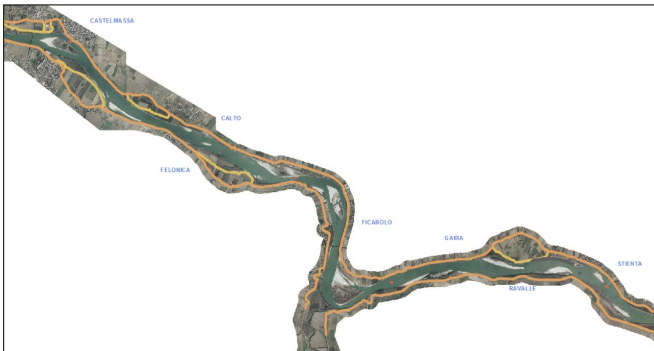
Figura 3: tratto di Po interessato dalle opere di sistemazione con l'evidenziazione delle arginature maestre e golenali
